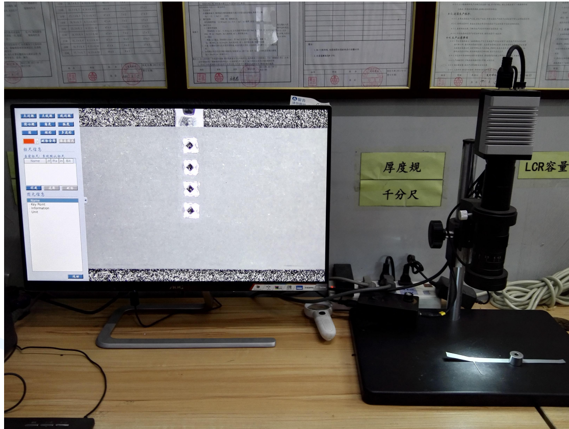
铝箔毛刺检查设备, 高倍率显微镜
